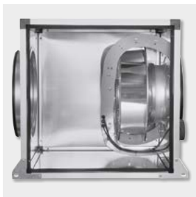
Rückwärts gekrümmte Radiallaufräder Statisch und dynamisch ausgewuchtet gemäß ISO 1940, aus Aluminium
