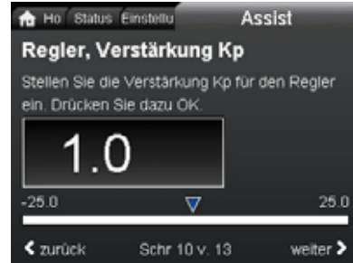
Abb. 55 "Regler, Verstärkung K p "
