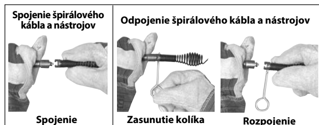
Obrázok 7 – Pripájanie a odpájanie nástrojov
