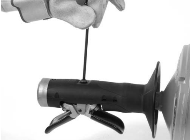
Figura 12A – Extracción del tornillo de la AUTOFEED
