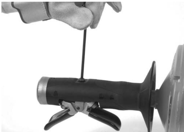
Obrázek 12A - Odšroubování šroubu AUTOPOSUVU
