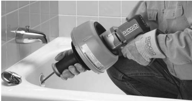
Figur 9 – Skub af spiralen ned i afløbsrøret
