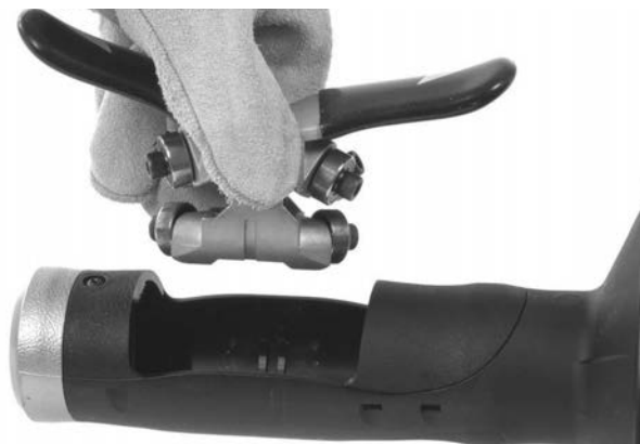
Obrázok 12B – Demontáž mechanizmu AUTOFEED z puzdra
