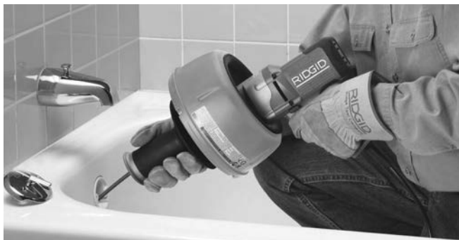
Figuur 9 – Duw de veer in de afvoerleiding
