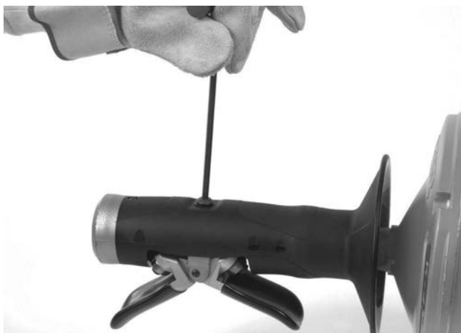
Figur 12A – Ta bort AUTOFEED-skruven
