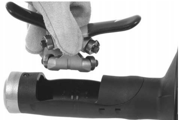
Εικόνα 12B – Αφαίρεση μηχανισμού AUTOFEED από το περίβλημα
