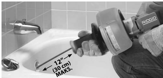
Kuva 8 – Tartu jouseen istukan avulla siirtämällä kahvaa kohti kela
