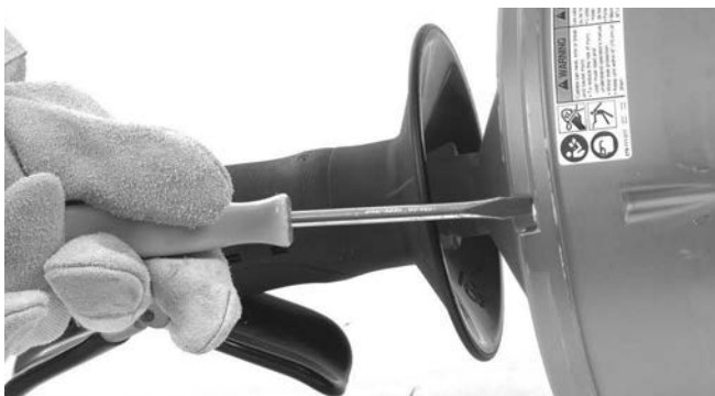
Obrázok 13 – Povolte 4 skrutky bubna približne o 3 celé otáčky, ale nevyberajte ich
