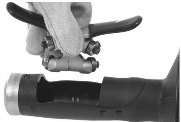
Obrázek 12B – Vyjímání mechanismu AUTOPOSUVU ze skříně
