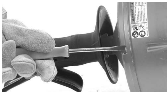
13. ábra – A dob 4 db csavarját lazítsa ki kb. 3 teljes fordulatnyival, de ne vegye ki őket
