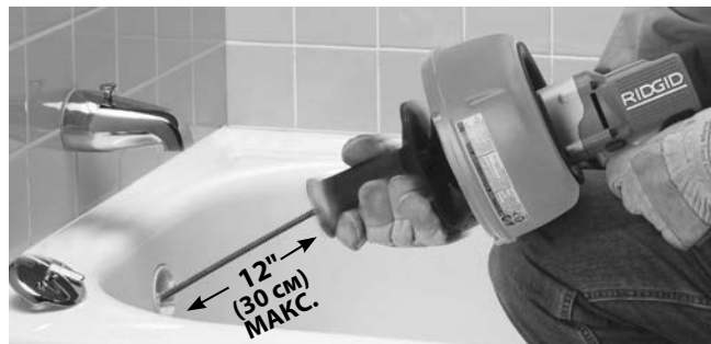
Рис. 8 – Переместите рукоятку к барабану, чтобы захватить трос зажимным патроном
