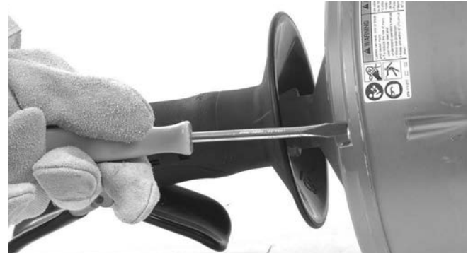
Kuva 13 – Löysää kelan neljää ruuvia noin 3 täyttä kierrosta, mutta älä irrota ruuveja
