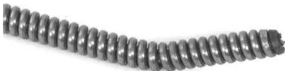
15. ábra – Megtörés a kábelvégnél
