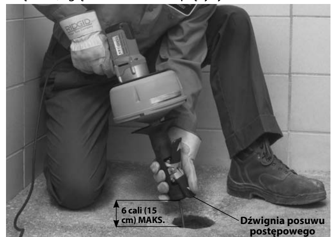
Rys. 10 – Wprowadzanie sprężyny za pomocą mechanizmu autoposuwu AUTOFEED
