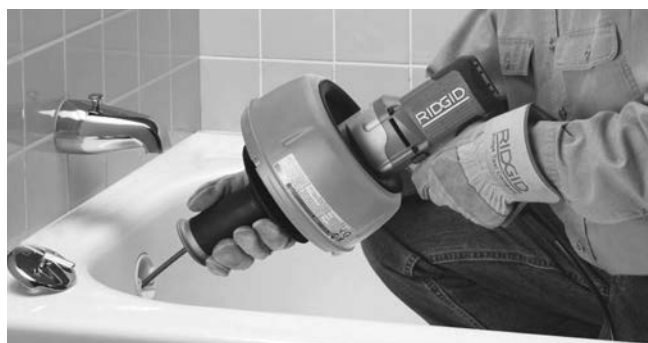
Kuva 9 – Työnnä jousi sisään viemäriin
