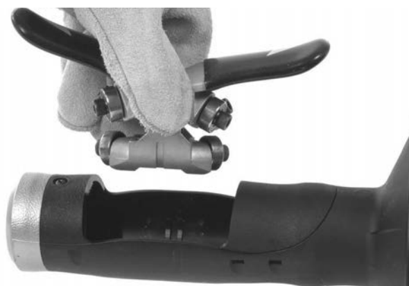
Figura 12B – Demontarea mecanismului AUTOFEED din carcasa
