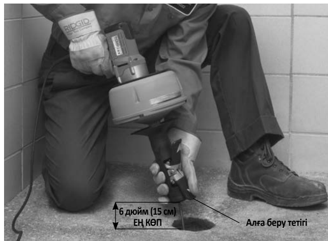
10-сурет – Кабельді AUTOFEED (АВТОМАТТЫ БЕРУ) арқылы беру
