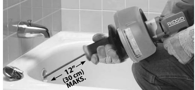
Şekil 8 - Kabloyu Mandrenle Kavramak için Tutamağı Makaraya Yaklaştırın
