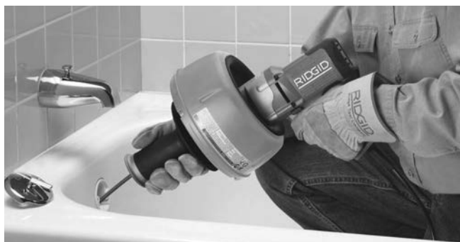
9. ábra – Tolja a lefolyóba a kábelt
