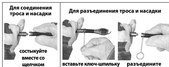
Рис. 7 – Подсоединение и отсоединение насадок
