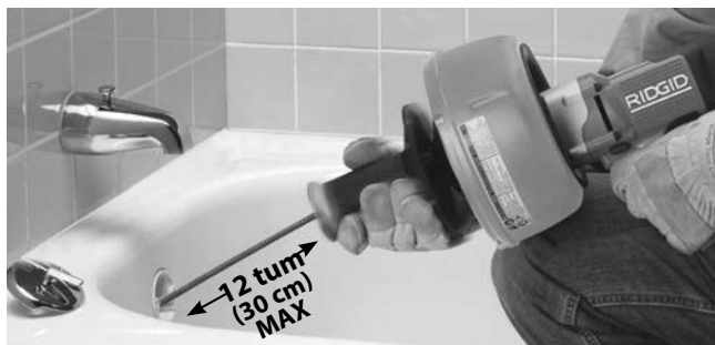
Figur 8 – Flytta handtaget mot trumman för att greppa vajern med chucken
