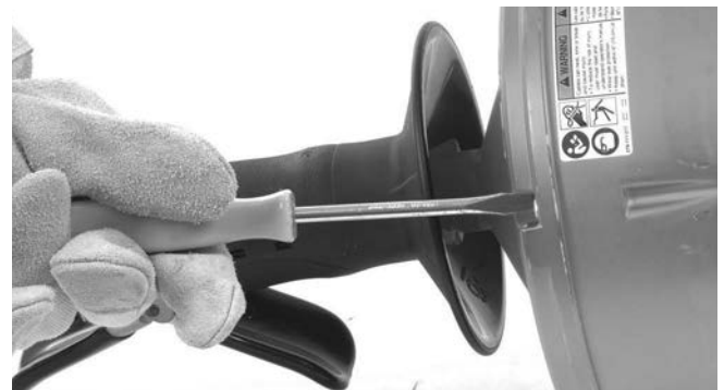
Slika 13 – Olabavite 4 zavrtnja bubnja za oko 3 puna okreta, ali ih nemojte skidati
