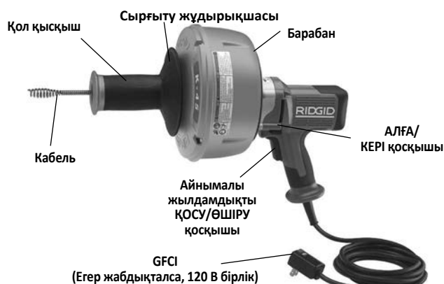
1-сурет – Сырғыту жұдырықшасы бар K-45 ағын құбырын тазалау құрылғысы
