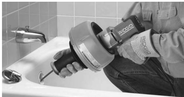
Slika 9 – Guranje sajle duž odvodne linije
