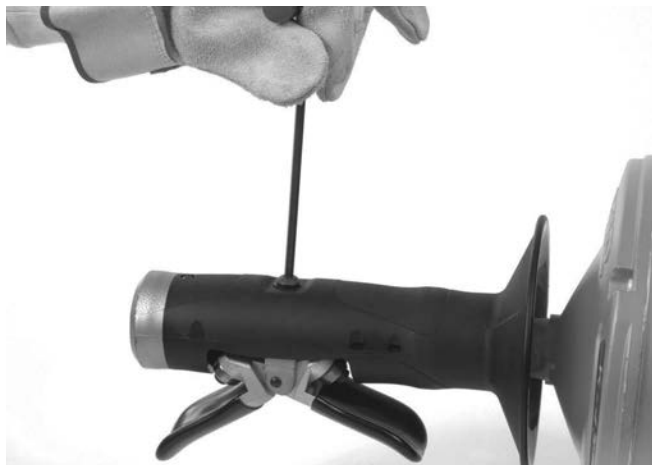
Rysunek 12A - Wykręcanie śruby mechanizmu AUTOFEED
