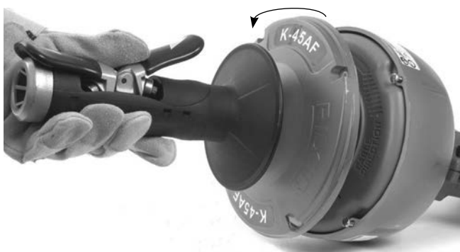
14. ábra – A dob szétcsavarása
