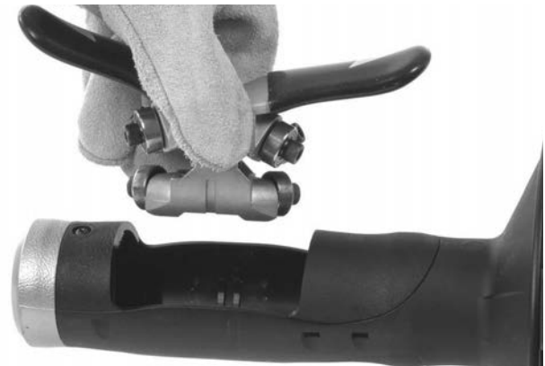
Figur 12B – Afmontering af AUTOFEED-mekanismen fra huset
