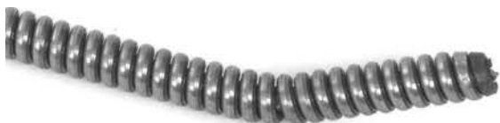
Slika 15 – Upogib na koncu kabla
