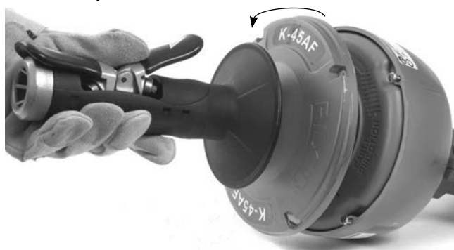
Rysunek 14 – Rozkręcić bęben
