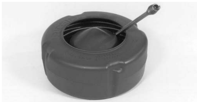
Figur 16 – När du lägger på spiral på en innertrumma ska spiralen lindas MEDURS.
