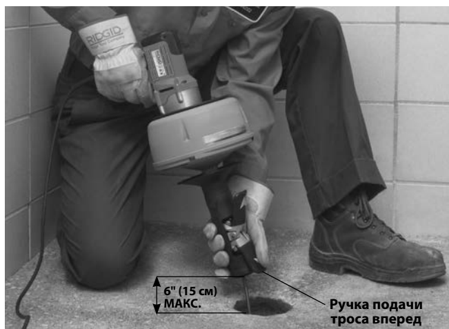
Рис. 10 – Подача троса с помощью устройства AUTOFEED
