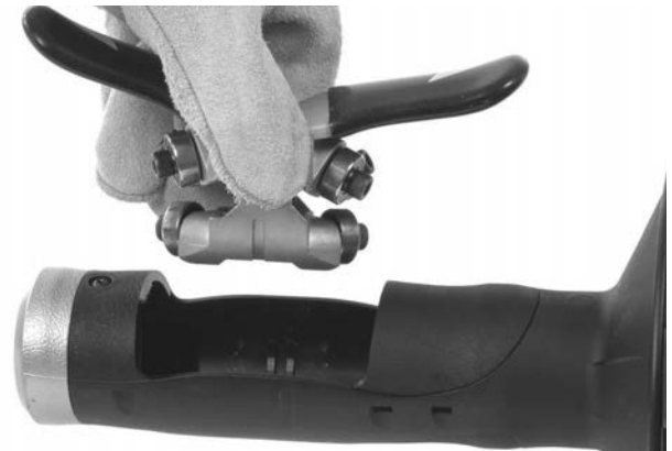
Figura 12B – Rimozione del meccanismo AUTOFEED dall'alloggiamento
