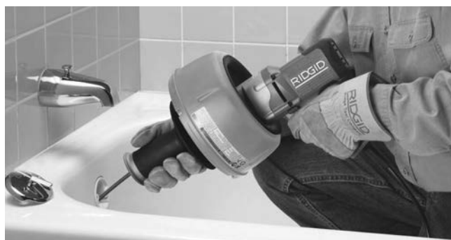
Slika 9 - Gurnite sajlu niz odvod
