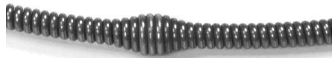
Figur 11 – C-13-IC SB spiral med spiraländesindikator (Speedbump) är ca 84 tum (2,1 m) från spiralens bakre ände
