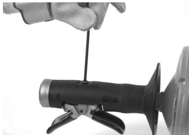
Figura 12A – Demontarea șurubului AUTOFEED
