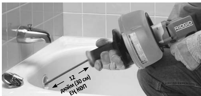
8-сурет – Кабельді жұдырықшамен қысу үшін қол қысқышты барабанға қарай жылжыту
