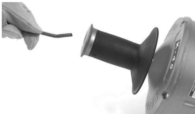
Figur 17 – Lasting av kabel uten å skifte innertrommel
