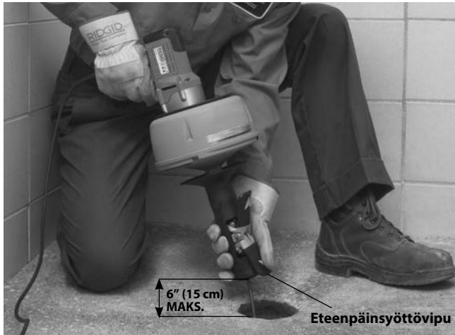
Kuva 10 – Jousen syöttäminen automaattisyötöllä
