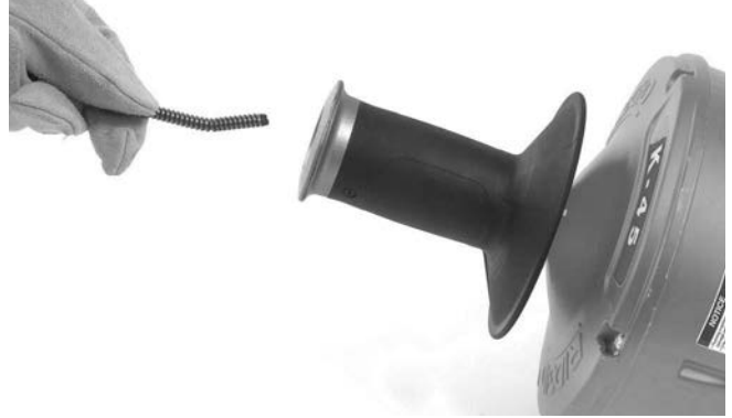
Şekil 17 - İç Makarayı Değiştirmeden Spiral Yüklenmesi
