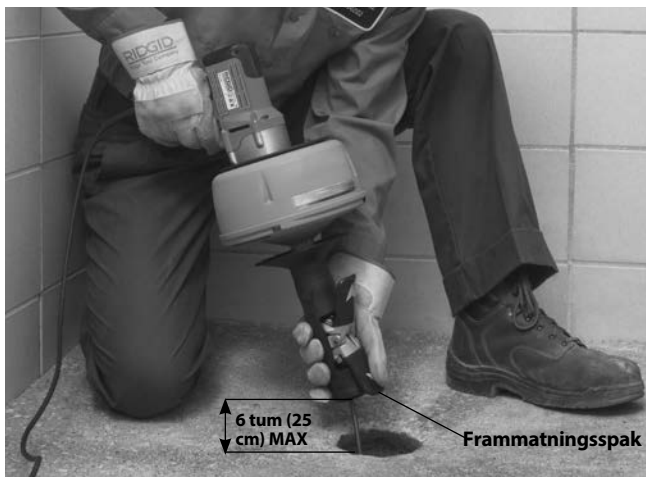
Figur 10 – Mata spiral med AUTOFEED
