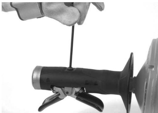
Figura 12A – Retirar o Parafuso AUTOFEED
