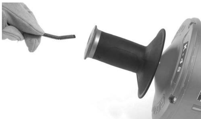
Figur 17 – Indføring af spiral uden skift af indertromlen
