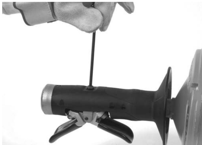
Рис. 12A – Отворачивание винта крепления устройства автоподачи AUTOFEED
