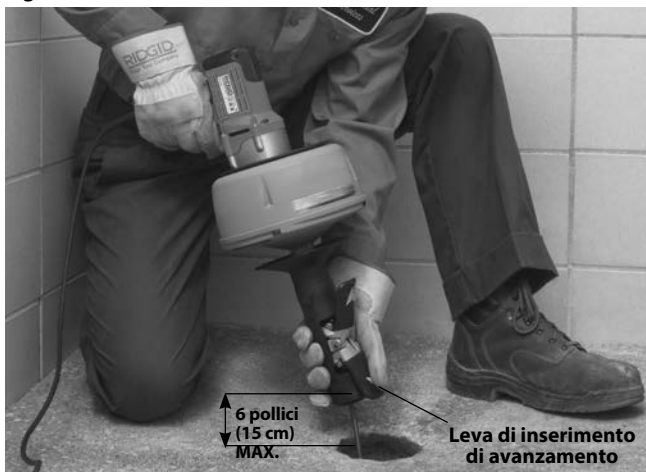
Figura 10 – Inserimento del cavo in modalità AUTOFEED
