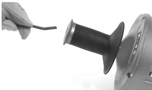
Рис. 17 – Заправка троса без замены внутреннего барабана
