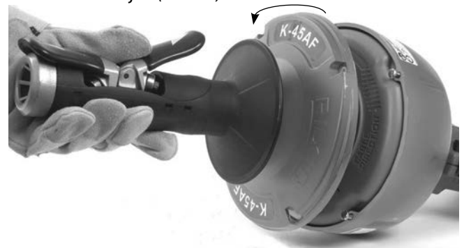
Slika 14 – Zakretanje odvojenog bubnja
