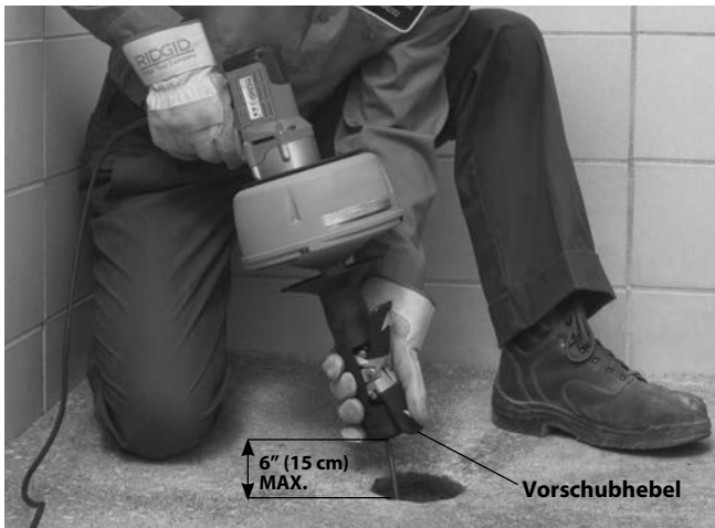
Abbildung 10 – Vorwärtsschieben der Spirale mit AUTOFEED
