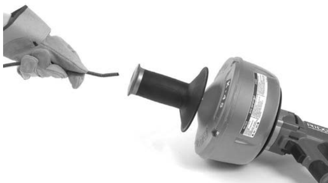
Figura 17 – Carregar o cabo sem substituir o tambor interno
