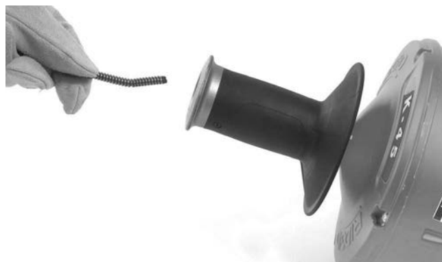
Figura 17 – Încărcarea cablului fără schimbarea tamburului interior
