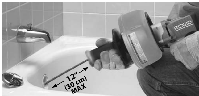
Obrázek 8 – Pro uchopení kabelu upínacím pouzdem posuňte rukojeť k bubnu
