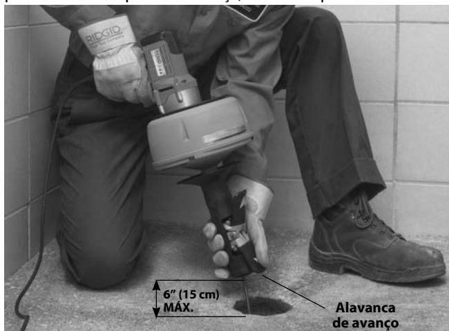
Figura 10 – Avançar o cabo com AUTOFEED
