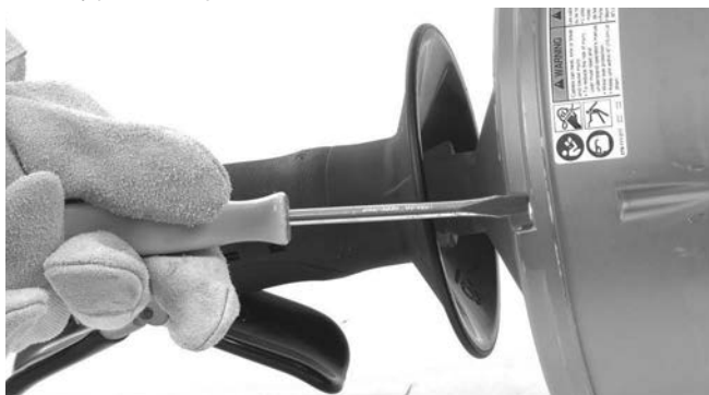
Εικόνα 13 – Λασκάρτε τις 4 βίδες του τύμπανου κατά 3 πλήρεις στροφές περίπου, αλλά μην τις αφαιρέσετε
