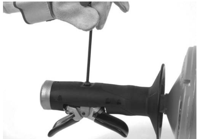
Abbildung 12A – Entfernen der AUTOFEED Schraube
