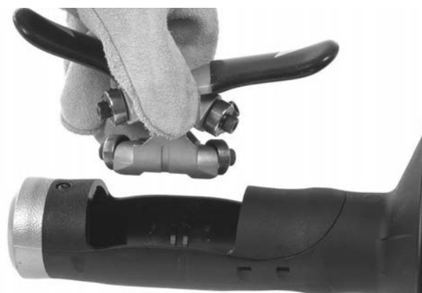
Figura 12B – Retirar o Mecanismo AUTOFEED do Alojamento
