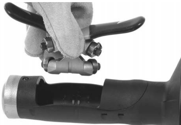
Slika 12B – Skidanje AUTOFEED mehanizma sa kućišta
