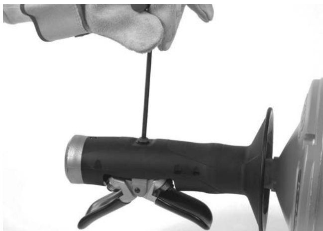
Figuur 12A – Verwijderen van de AUTOFEED-schroef
