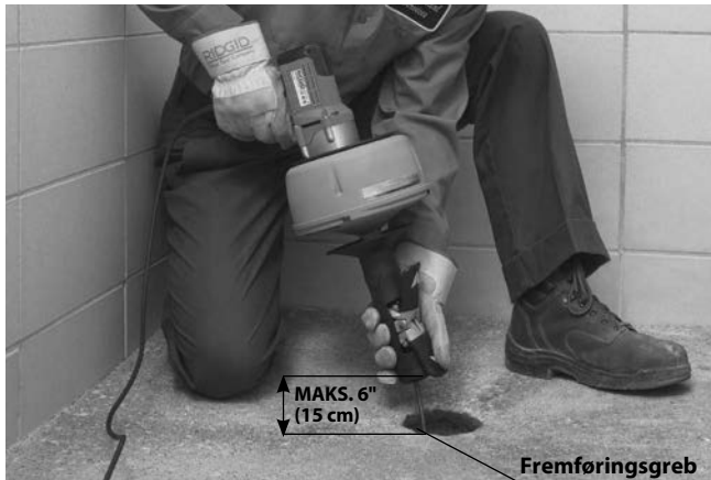
Figur 10 – Fremføring af spiral med AUTOFEED
