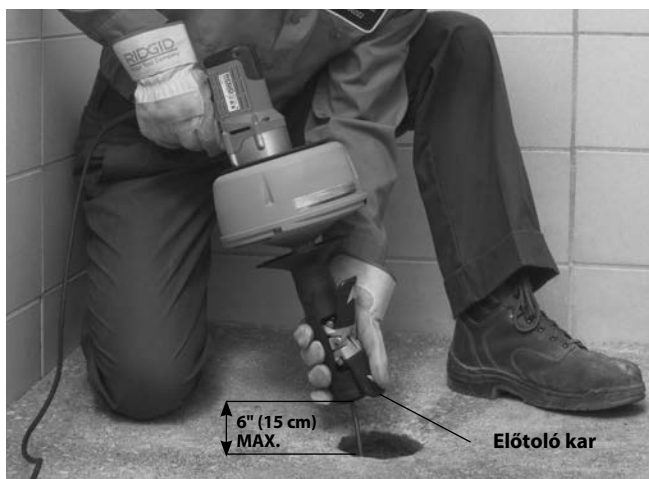
10. ábra – A kábel előtolása az AUTOFEED funkcióval
