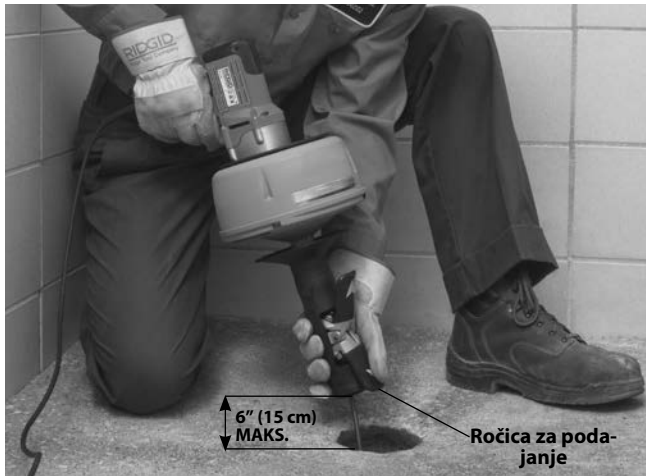
Slika 10 – Podajanje kabla skozi podajalnik AUTOFEED
