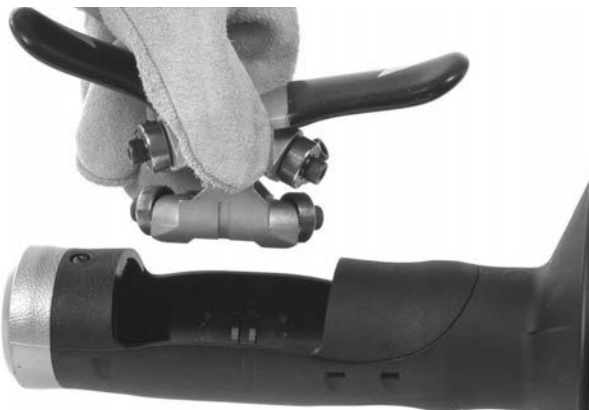
Figur 12B – Fjerning av AUTOFEED-mekanisme fra hus
