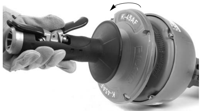
Figura 14 – Apertura de la tapa del tambor exterior
