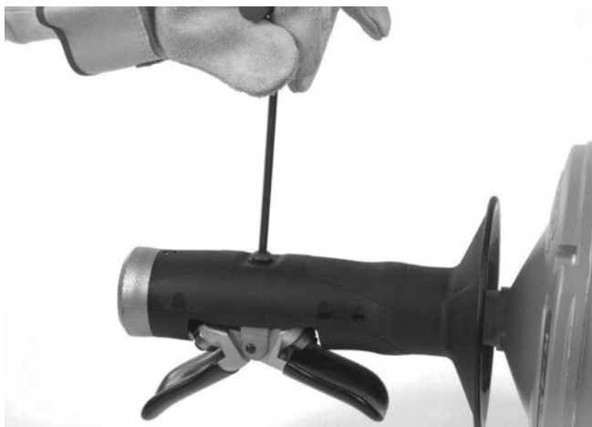
12A ábra – Az AUTOFEED csavar eltávolítása
