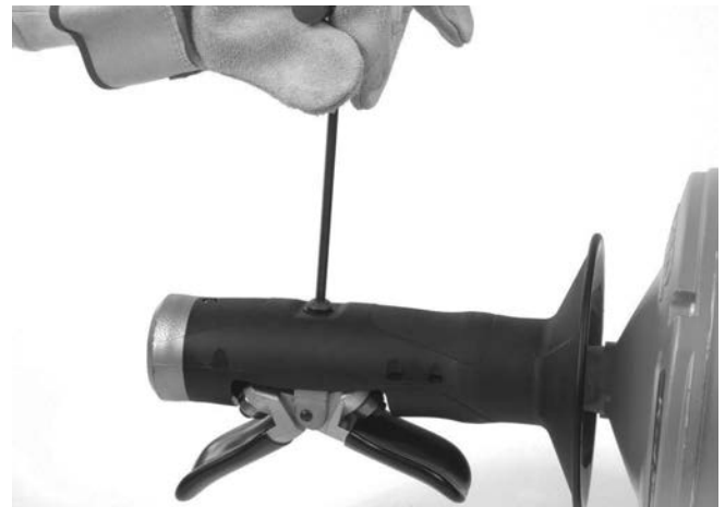
Figur 12A – Fjernelse af AUTOFEED-skruen
