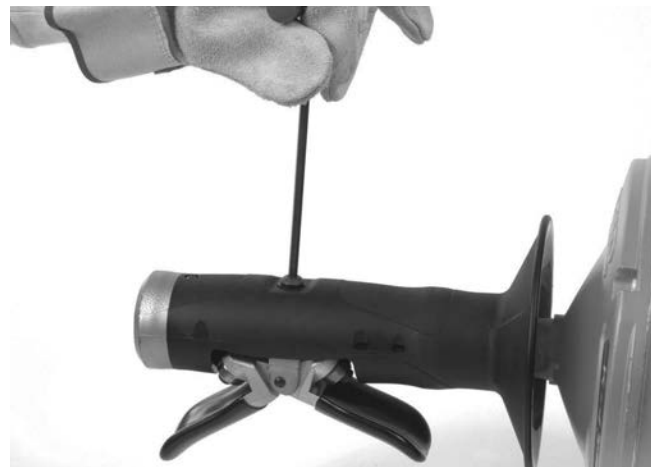
Obrázok 12A – Demontáž skrutky mechanizmu AUTOFEED
