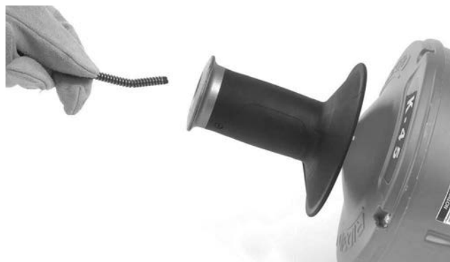
Εικόνα 17 – Τοποθέτηση σπιράλ χωρίς αλλαγή του εσωτερικού τύμπανου
