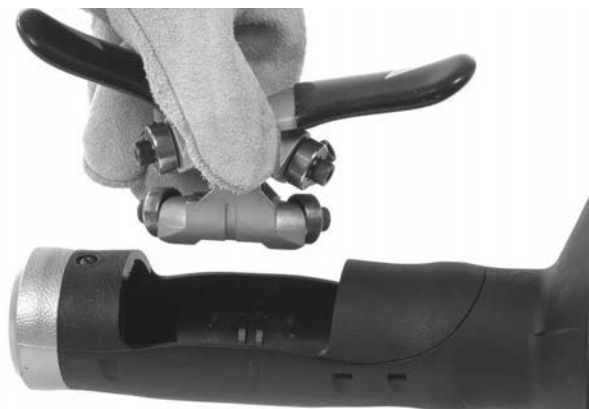
Рис. 12B – Снятие с корпуса устройства автоподачи AUTOFEED
