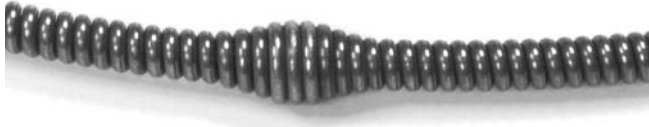
Figuur 11 – C-13-IC SB Veer met veereinde-indicator. De 'speedbump' zit op ongeveer 84" (2,1 m) van het einde van de veer
