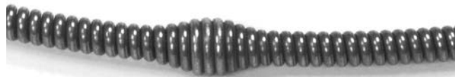
Εικόνα 11 – Το σπιράλ C-13-IC SB με το σύστημα ένδειξης άκρου σπιράλ Speedbump βρίσκεται περίπου 84" (2,1m) από το πίσω άκρο του σπιράλ
