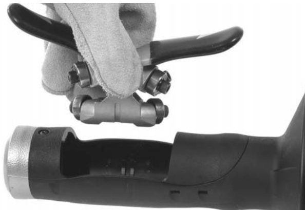
Slika 12B – Skidanje AUTOFEED mehanizama s kućišta
