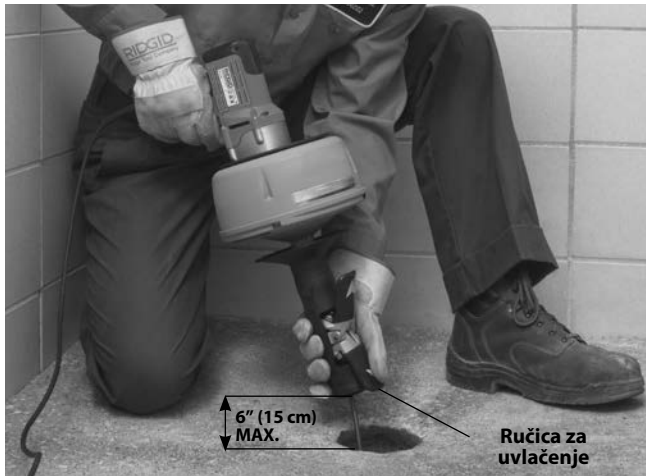
Slika 10 – Sprovođenje sajle sa AUTOFEED
