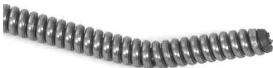
Obrázek 15 – Ohyb na konci kabelu
