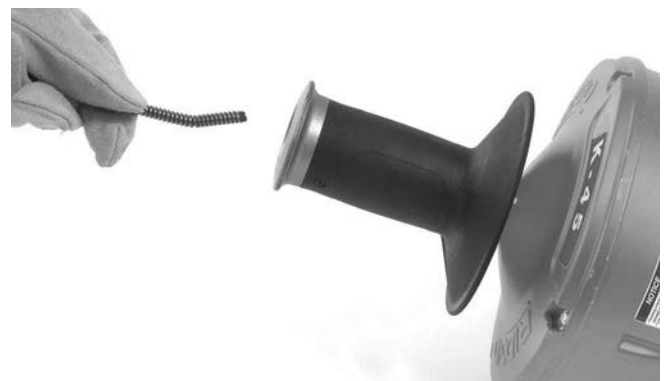
Abbildung 17 – Einlegen der Spirale ohne Wechsel der Innentrommel
