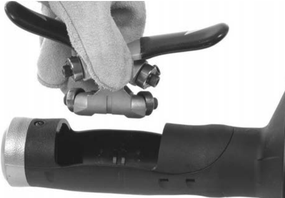
Şekil 12B - AUTOFEED Mekanizmasının Muhafazadan Çıkartılması
