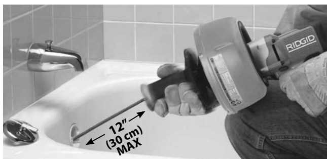
Slika 8 – Pomeranje rukohvata prema bubnju da bi zahvatili sajlu steznom glavom
