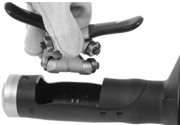
Figura 12B – Extracción del mecanismo de la AUTOFEED
