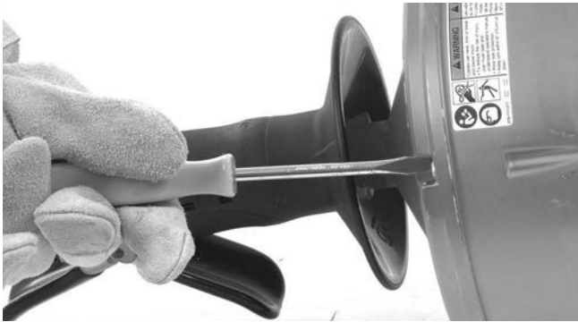
Abbildung 13 – 4 Trommelschrauben etwa 3 Umdrehungen lösen, aber nicht entfernen
