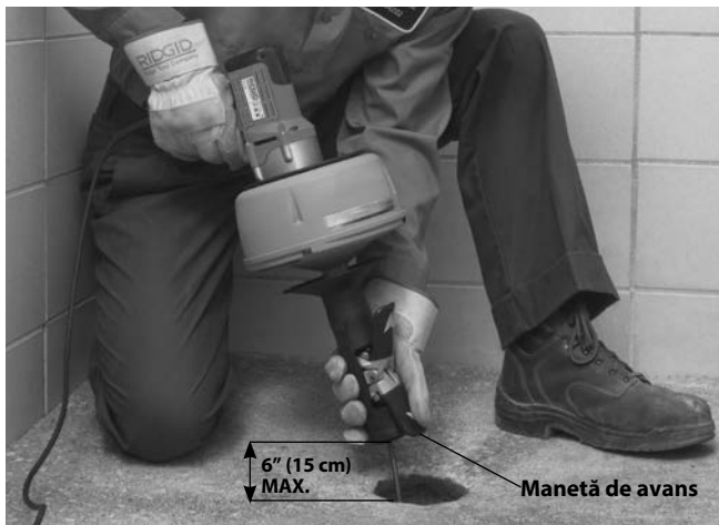
Figura 10 – Avansarea cablului cu AUTOFEED
