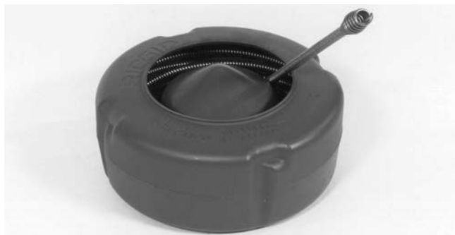
Obrázok 16 – Pri zavádzaní kábla do vnútorného bubna kábel navíjajte V SMERE HODINOVÝCH RUČÍČIEK.
