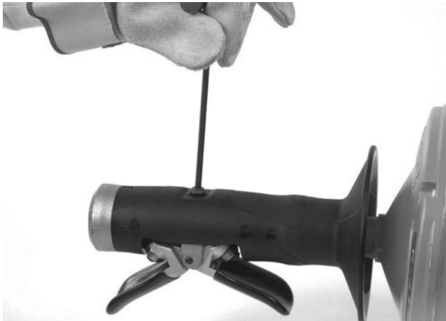
Kuva 12A – AUTOFEED-ruuvin irrottaminen
