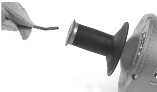
Slika 17 – Uvlačenje sajle bez zamene unutrašnjeg bubnja
