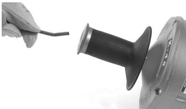
Kuva 17 – Jousen lataaminen vaihtamatta sisäkela
