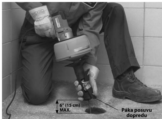
Obrázok 10 – Zavádzanie kábla pomocou funkcie AUTOFEED
