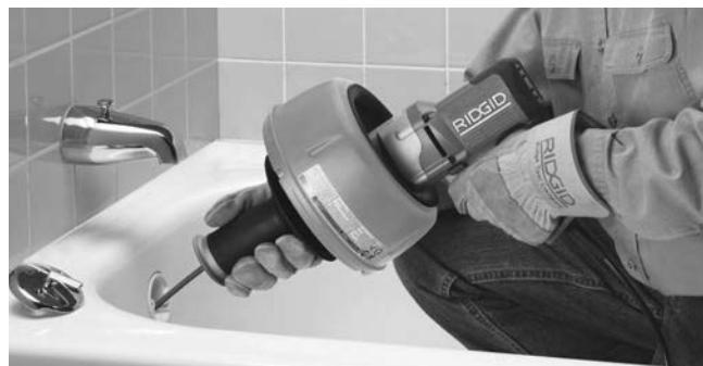
Εικόνα 9 – Ωθήστε το σπιράλ μέσα στον αγωγό αποχέτευσης
