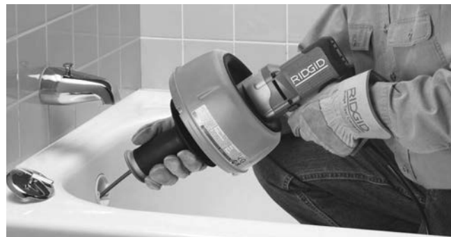
Рис. 9 – Протолкните трос дальше в канализационную трубу
