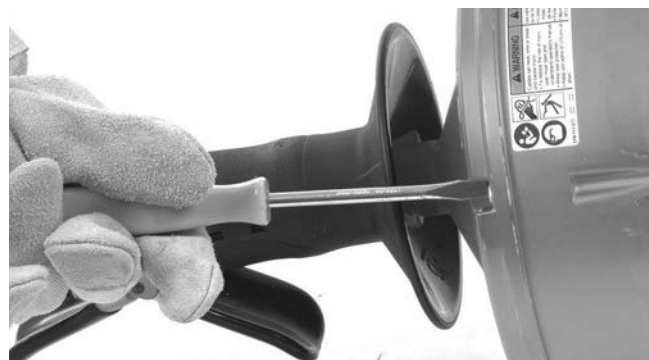
Figuur 13 – Draai de 4 schroeven van de trommel ongeveer 3 hele slagen los, maar verwijder ze niet
