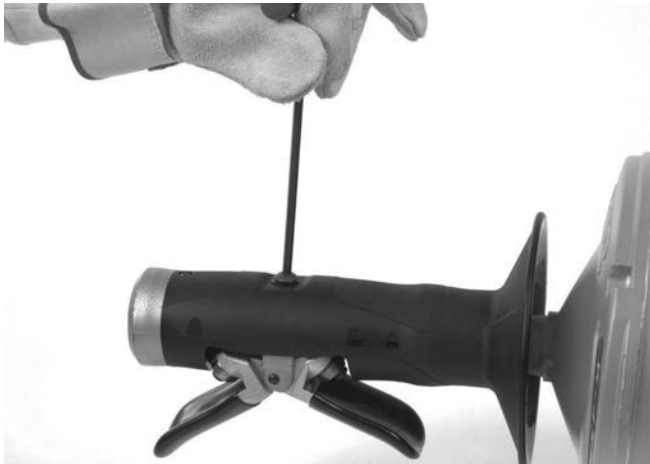
12А-сурет – AUTOFEED (АВТОМАТТЫ БЕРУ) бұрандасын шешу
