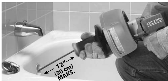
Slika 8 – Ročaj premaknite proti bobnu, da primete kabel z vpenjalno glavo
