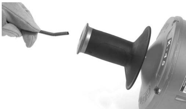
Obrázok 17 – Zavedenie kábla bez výmeny vnútorného bubna
