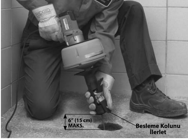
Şekil 10 – Kablunun AUTOFEED İle Beslenmesi
