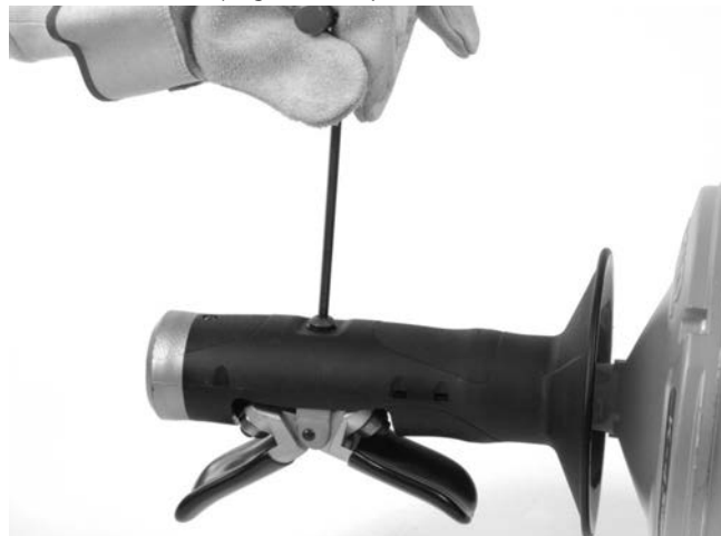
Figure 12A – Retrait de la vis de l'AUTOFEED
