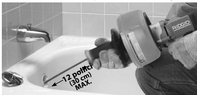
Figura 8 – Spostare l'impugnatura verso il tamburo per fare presa sul cavo con il mandrino
