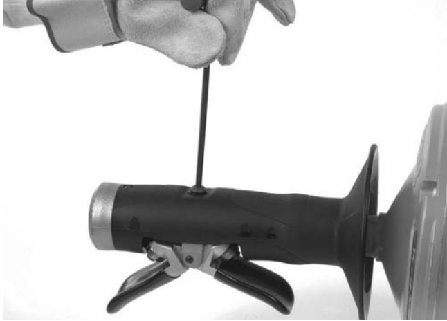
Şekil 12A - AUTOFEED Vidasının Çıkartılması
