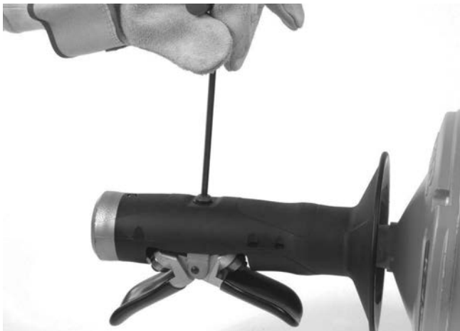
Slika 12A – Odstranjevanje vijaka sistema AUTOFEED
