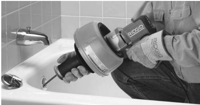
Figur 9 – Skjut spiralen längs avloppsledningen
