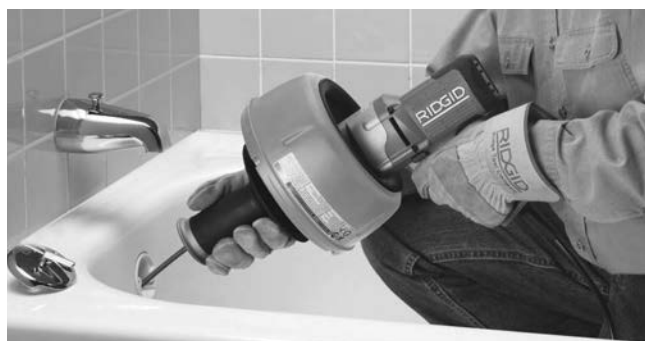
Slika 9 – Kabel potisnite v odtok
