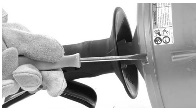
Figure 13 – Desserer les 4 vis de tambour externe de trois tours, sans les enlever
