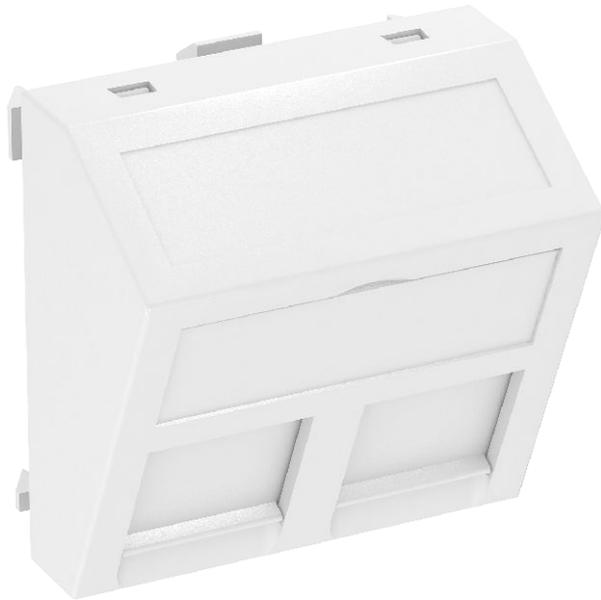
Datentechnikträger mit schrägem Auslass und Verschlusschieber zur Aufnahme von zwei Datentechnik-Anschlussmodulen mit RJ45-Buchse. Die Rastbefestigung eignet sich für den waagerechten und senkrechten Einbau in die Systemumgebung. Typ B hat eine Montageöffnung von 19,35/21,55 X 14,85 mm und ist für die direkte Befestigung der Daten-Anschlussmodule in der Montageöffnung ausgelegt.
