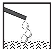
Kondensat darf nicht in das Gerät gelangen. Bei Minustemperaturen, durch Vereisung Fehlfunktion/Ausfall möglich.
