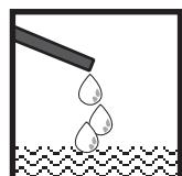
Laitteeseen ei saa päästää lauhdevettä. Minuslämpötiloissa kytkimen jäätyminen voi aiheuttaa toimintahäiriötä.
